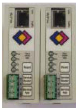
Fig 1 Multiple DIN eNode™IV Lon/IP 852 Router Modules
